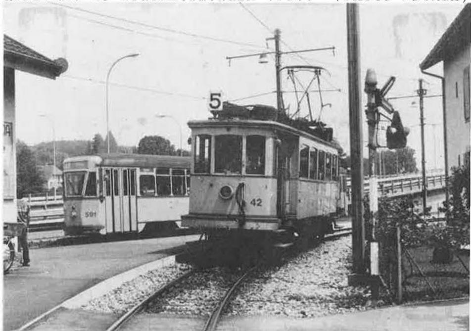
Les bogies présentaient une construction assez particulière et compacte avec une suspension primaire par barres de torsion, tandis que la secondaire comportait de gros ressorts à boudin. Néanmoins, au-delà d'une certaine vitesse, ce type de mécanisme se révéla insuffisant pour garantir un bon roulement. Au cours des dernières révisions, la suspension a été améliorée dans la perspective de l'utilisation de ces motrices sur la ligne 5 où la vitesse maximale est couramment pratiquée.
